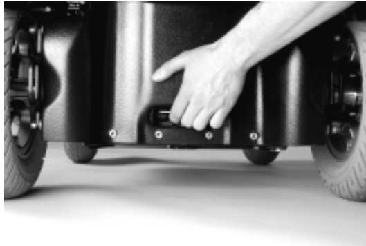
Abbildung 21: Betätigung des Batterieschubs
