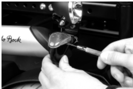
Abbildung 36: Öffnen des Frontblinkers
