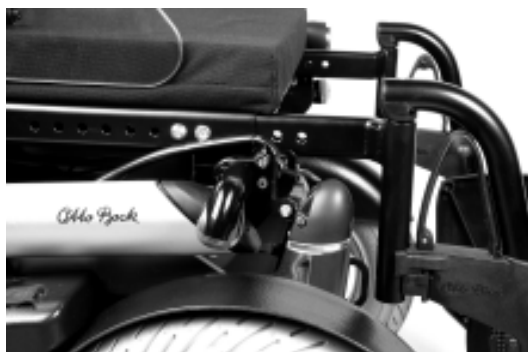
Abbildung 14: Umklappen der Frontbeleuchtung
