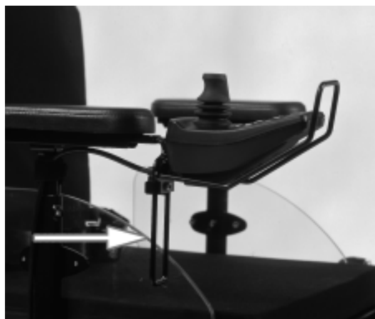
Abbildung 26: Bedienpult nach unten verstellbar
