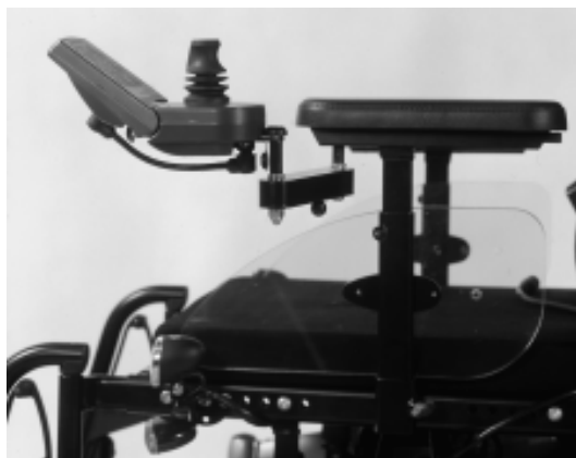
Abbildung 28: Bedienpult seitlich abschwenkbar
