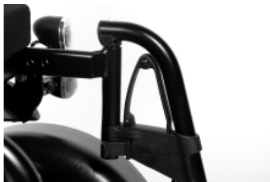
Abbildung 8: Arretierung der Fußraste
