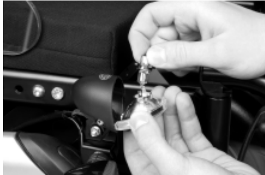
Abbildung 35: Wechsel des Frontlichtes
