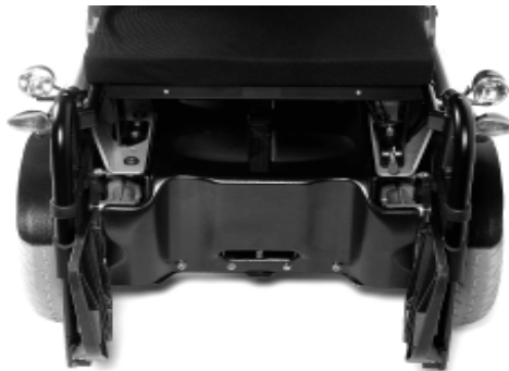
Abbildung 11: Hochklappen der Fußbretter
