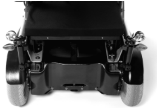
Abbildung 12: Abnehmen der Fußrasten
