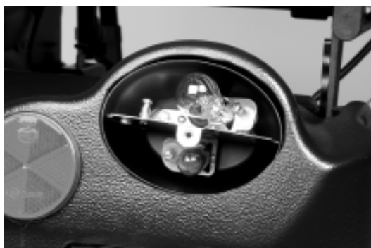
Abbildung 39: Wechsel Heckblinker und Heckbeleuchtung
